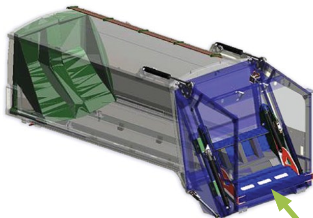
Le compacteur se met en arrêt lorsque le chargement maximal est atteint
